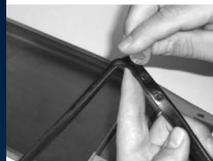
6. Installez maintenant le joint de la cassette en plaçant d'abord le joint dans les coins arrière de sorte que les DEUX TROUS S'ALIGNENT ENTRE LE JOINT ET LE PLATEAU DE CASSETTE. (C'est une étape critique afin d'éviter une mauvaise pose du joint) (voir l'image 6).
